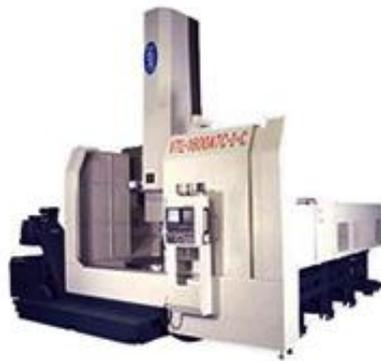
Вертикальные токарные станки с ЧПУ серии VTL разработаны на основе старших моделей серии VV. Основные изменения коснулись конструкции станины - она стала симметричной и более массивной. Модели VTL-3000 и 4000 имеют П-образную колонну. Это позволило ещё в большей мере увеличить жесткость и температурную стабильность станка.
