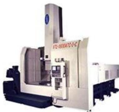
Вертикальные токарные станки с ЧПУ серии VTL разработаны на основе старших моделей серии YV. Основные изменения коснулись конструкции станины - она стала симметричной и более массивной. Модели VTL-3000 и 4000 имеют П-образную колонну. Это позволило ещё в большей мере увеличить жесткость и температурную стабильность станка.
