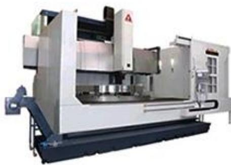
В вертикальных карусельных станках You Ji серии VTH серии VTH воплощены все преимущества станков серии VTL, но планшайба установлена на гидростатические опоры, что позволяет повысить нагрузочную способность планшайбы, увеличить виброустойчивость всей системы, снизить интенсивность износа наиболее нагруженных узлов станка до минимума.
