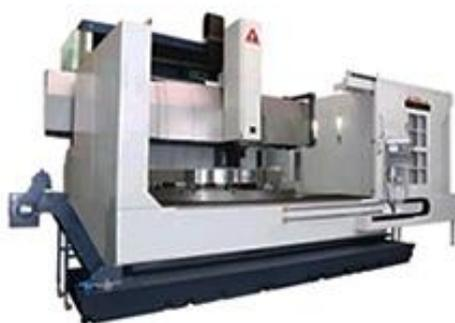
В вертикальных карусельных станках You Ji серии VTN серии VTN воплощены все преимущества станков серии VTL, но планшайба установлена на гидростатические опоры, что позволяет повысить нагрузочную способность планшайбы, увеличить виброустойчивость всей системы, снизить интенсивность износа наиболее нагруженных узлов станка до минимума.
